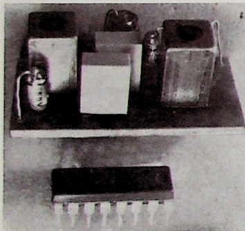
Bild 8 (unten). Praktische Ausführung des Vierkreis-Hybridfilters im Vergleich zu einem 16poligen Dual-in-line-Gehäuse
